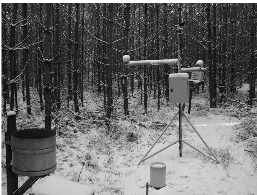
Obr. 1: Klimatická stanice s automatickým záznamem umístěná na experimentu s výchovou borových porostů Týniště
