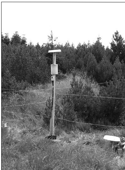
Obr. 2: Záznamník teplot na lokalitě VP Kleč. Air-temperature measurement apparatus on the VP Kleč experimental plot.
