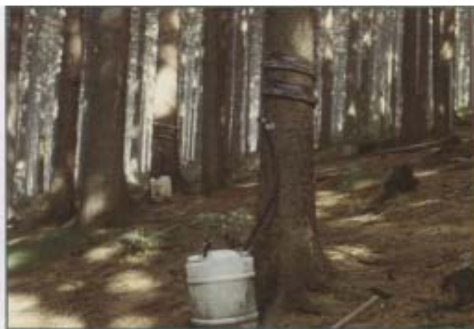
Obr. 3 Stok po kmenech smrků je nepodstatný i při přívalových srážkách
