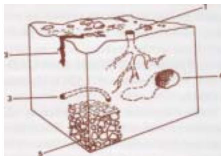
Obr. 4 Soustava makroporů vytvářejících gravitační vodní cesty v lesní půdě (1 - kanálky po odumřelých kořenech, 2 - mrazové trhliny, 3 - chodbičky půdních červů, 4 - nory malých živočichů, 5 - prostory mezi půdními agregáty)
